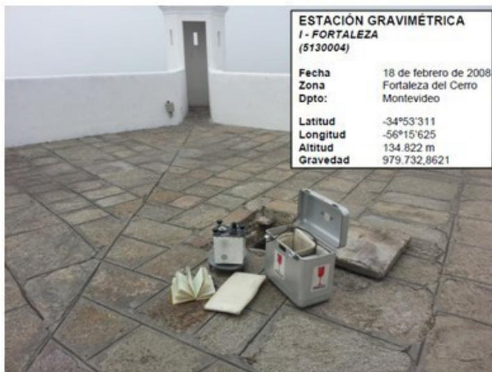
Figura 2. Estación gravimétrica Fortaleza (inicio del trabajo).
