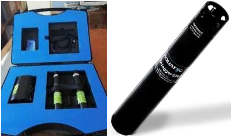
**Figura 4.** Sensor de presión AQUAlogger 520.
